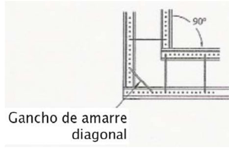
Figura 5.4.b. Gancho de esquina diagonal
