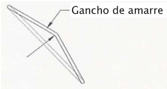
Figura 5.4.c. Corrección del gancho de esquina
