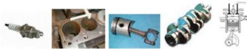
De izquierda a derecha: Bujía; Cilindro; Pistón; Cigüeñal; y todas esas partes ensambladas en el extremo.
