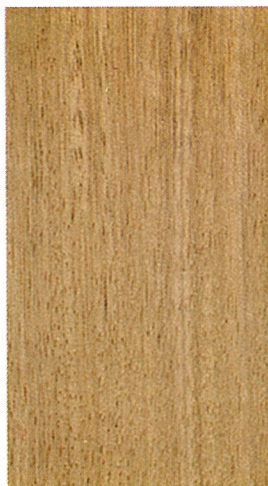
2c Sección radial longitudinal
