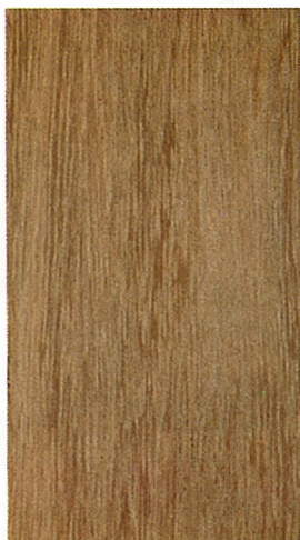
2b Sección tangencial longitudinal
