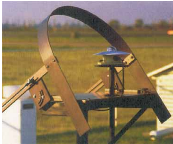
Figura 3.3. Piranómetro con banda de sombra para la medición radiación difusa
