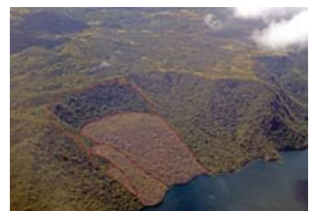
Figura 2. Deslizamiento complejo en la ladera de la caldera de la Laguna de Apoyo.
