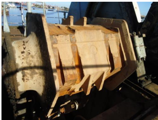
Figura 6.7 – Prisma superior original, véase la marca de los eslabones
