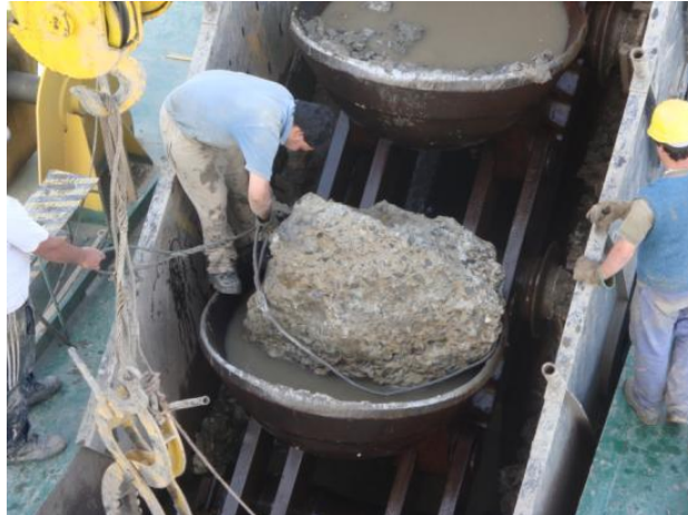
Figura 6.14 – Bloque de hormigón dragado
