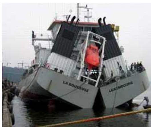
Figura 6.11 – Vista de la barcaza con el casco partido abierto
