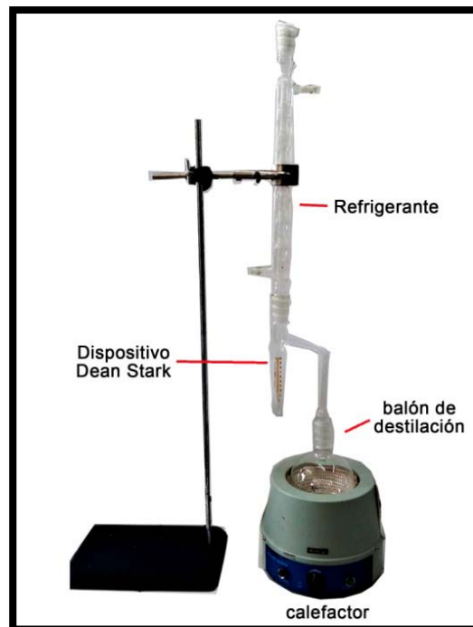
Figura 2: Equipo para determinación de humedad. Laboratorio de Bromatología.
