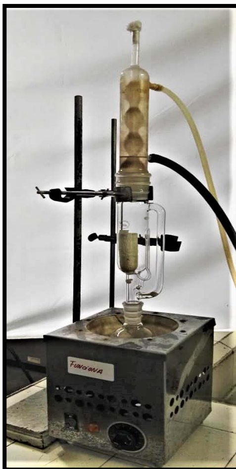
Figura 5: Equipo de Soxhlet. Laboratorio de Bromatología.
