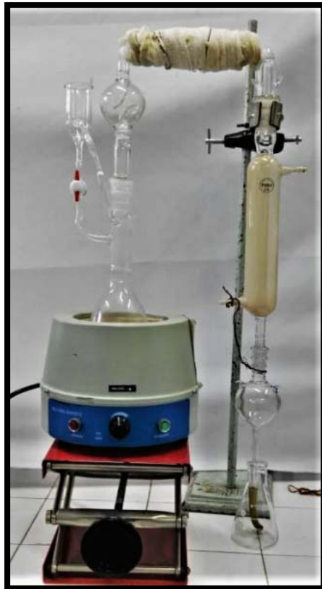
Figura 4: Equipo de destilación para determinación de proteínas por el Método de Kjeldahl. Laboratorio de Bromatología.
