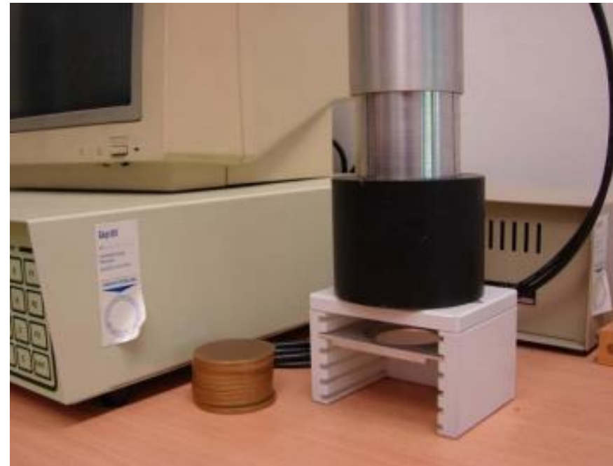
Detector NaI de 81cm de diámetro construido por Harshaw
