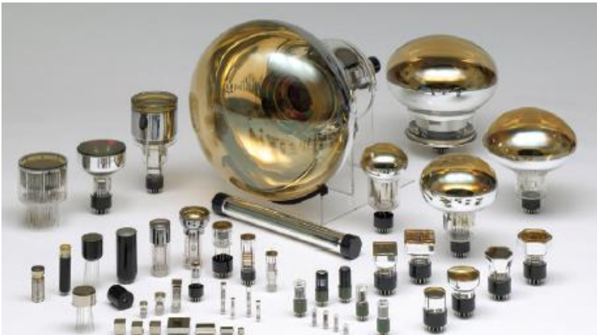
Figura 14: Fotomultiplicadores de diferentes formas y tamaños que se pueden construir o adquirir comercialmente.
