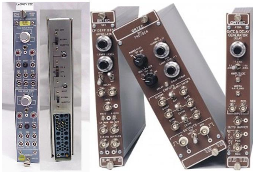
Figura 34: Módulos electrónicos contruidos de acuerdo a la estandarización NIM. Se observan módulos de ancho simple y doble y un módulo visto dese atrás para visualizar los conectores eléctricos.
