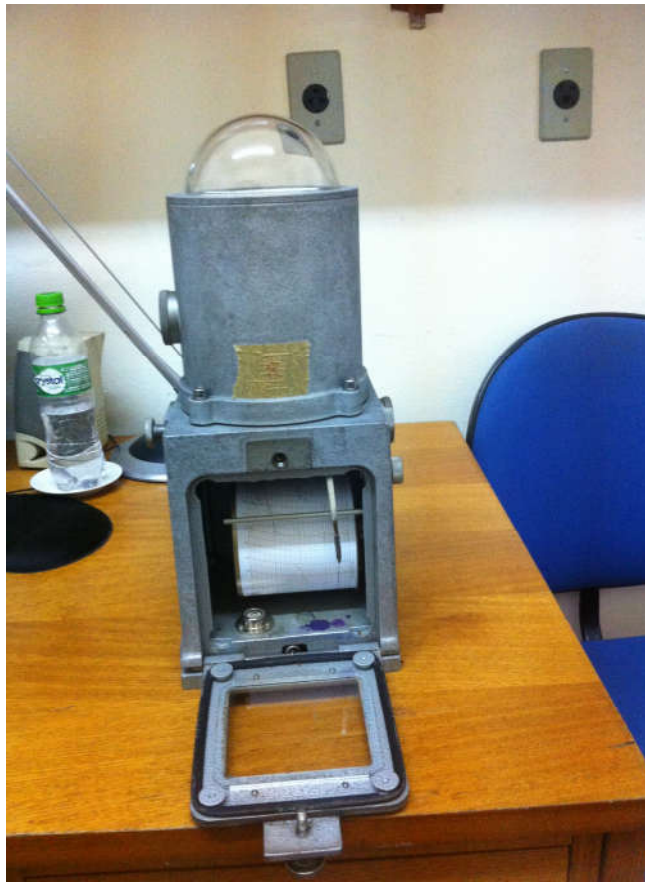
Figura 5 – Detalhe do sistema de gravação e da abertura da porta de acesso ao tambor.
