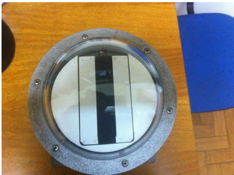
Figura 4 – Cúpula dos modelos 58d e 58dc (são iguais), mostrando a tira bimetálica partida, formando 3 tiras, sendo a central na cor preta e as laterais na cor branca.
