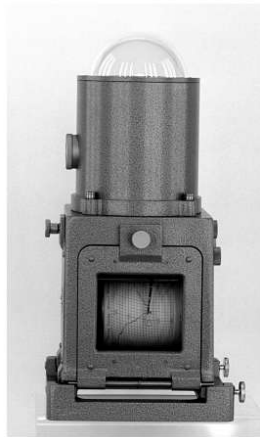
Figura 3 – Capa do panfleto de informações do Actinógrafo Bimetálico Robitzsch 58dc, da R. Fuess (Instrumento 2, conforme identificado anteriormente).
