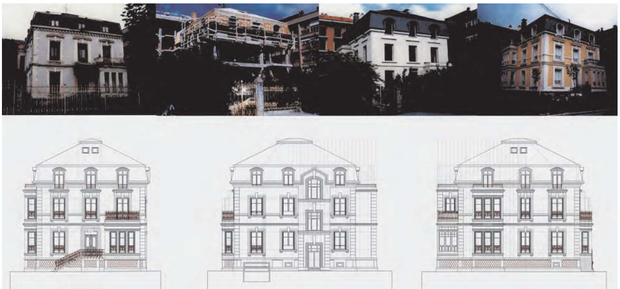
Figura 4. Estudio compositivo formal de un edificio del que no se conservará la materialidad: proyecto de reconstrucción del hôtel Katarro, 1996. Imagen: Ander de la Fuente.
