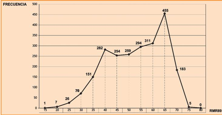
[Fig. 6].- Histograma de frecuencia del *RMR89* de la base de datos de *Geocontrol*.
