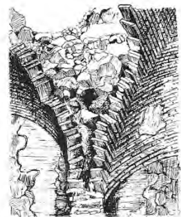
Figura 29-1. Puerta del Vado, del último término al primero, arco de herradura de piedra, arco de herradura de ladrillo de dovelaje completo y los dos arcos de medio punto de ladrillo del rastrillo, estos tres últimos como en Bisagra Vieja
