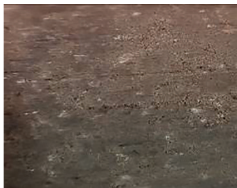
Fig. 4 – Aspectul materialului stabilizat după compactare
