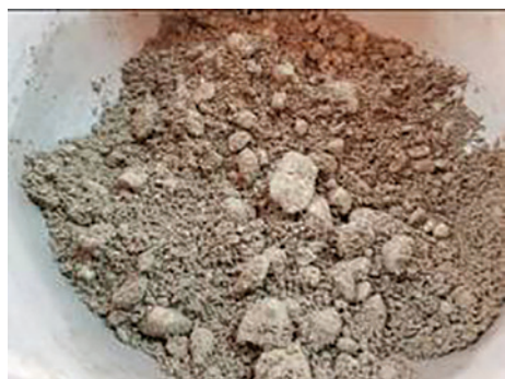
Fig. 3 – Aspectul amestecului agregat-liant, w_{opt} = 6\%
