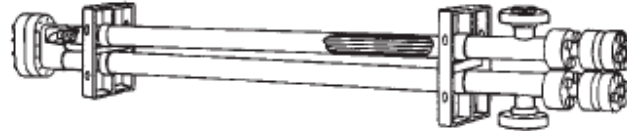
Fig. 6. Intercambiador doble tubo con aletas longitudinales FUENTE:[1]
