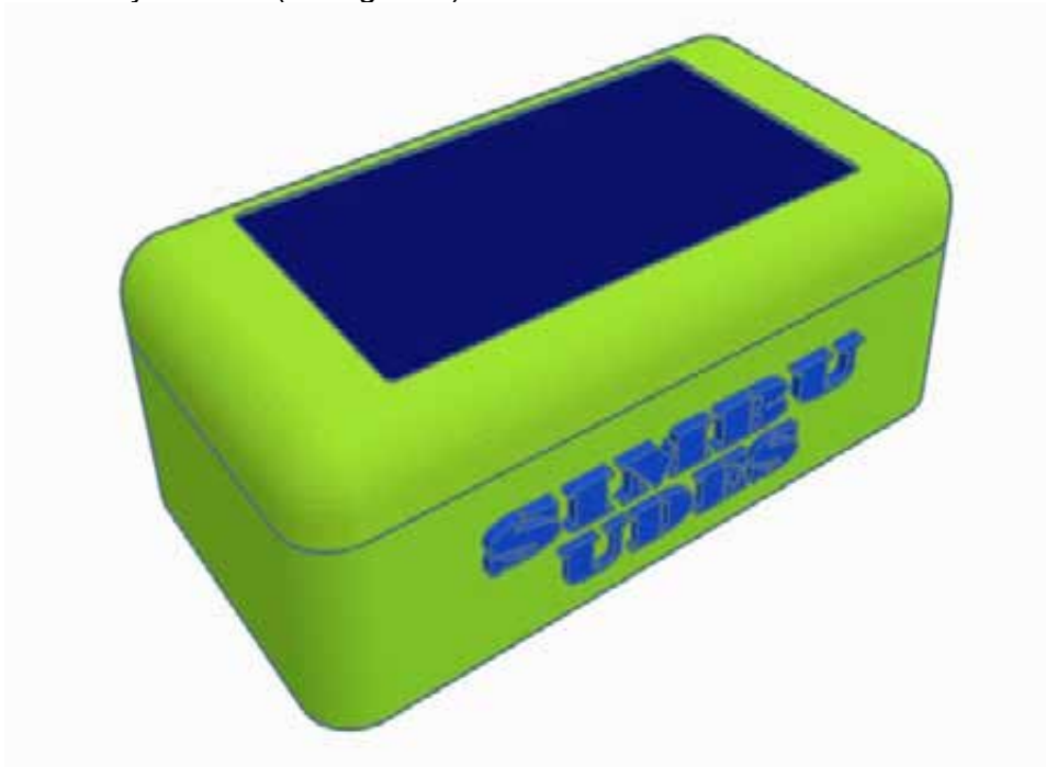
Figura 9. Modelo 3D de caja del dispositivo electrónico de medición de PM2.5
