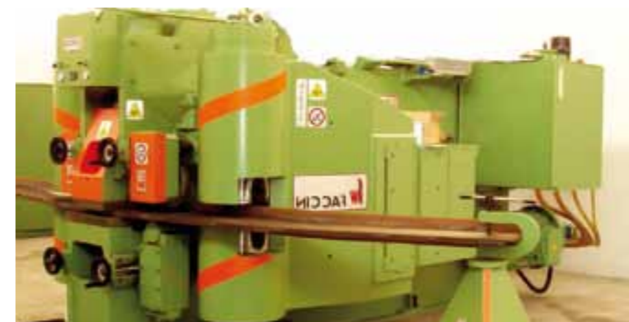
Curvadora especial para perfil Bulbo de aplicación en astilleros navales.
