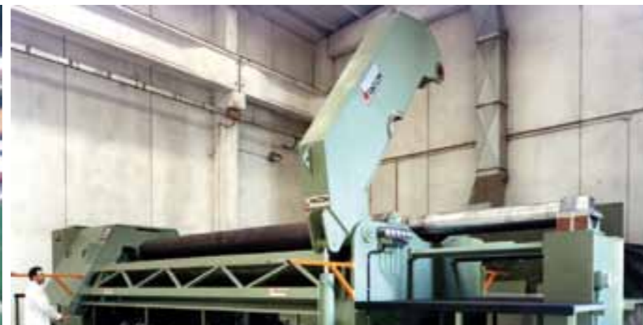
Versiones especiales de cilindros curvadores de 3 y 4 rodillos con rodillos superiores con precarga para curvatura de chapa con gran longitud y de grueso espesor (conductos de gas).
