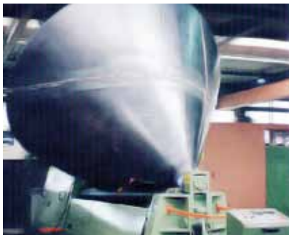
Con rodillos cónicos para líneas automáticas de curvatura cónica (para hormigoneras o industria alimentaria).
