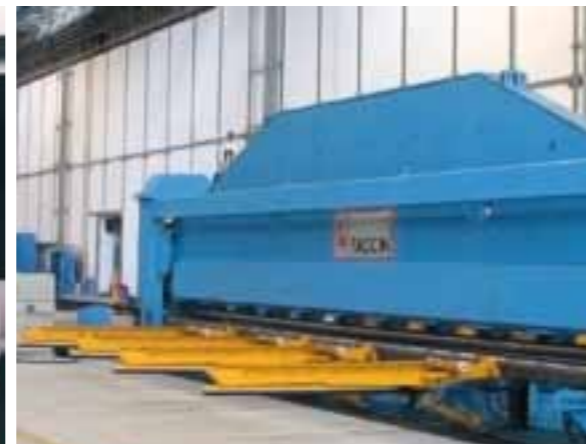
Cilindros curvadores especiales para los sectores aeroespacial y naval ideales para la producción de componentes HVAC hasta 21 metros de longitud útil.
