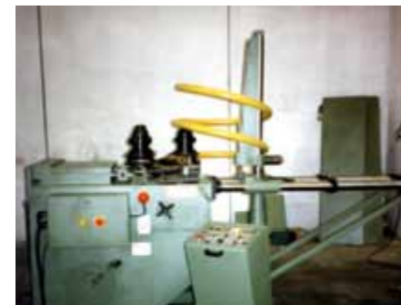
Utillaje y soportes de espirales para aplicaciones medio-pesadas.
