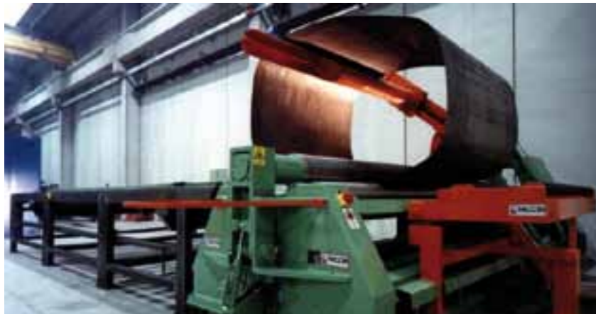
Cilindro curvador de 4 rodillos con control numérico gráfico CNC para curvado en automático de formas complejas.
