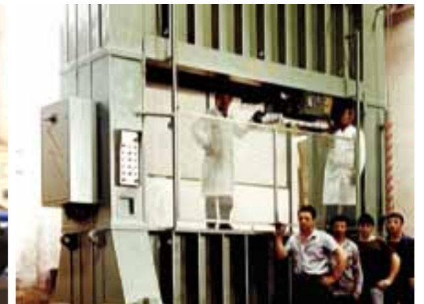
Las Prensas Hidráulicas son también diseñadas especialmente con el cabezal desplazable para realizar curvados o aplanados de la chapa. Dedicadas especialmente a fabricación general o astilleros navales.
