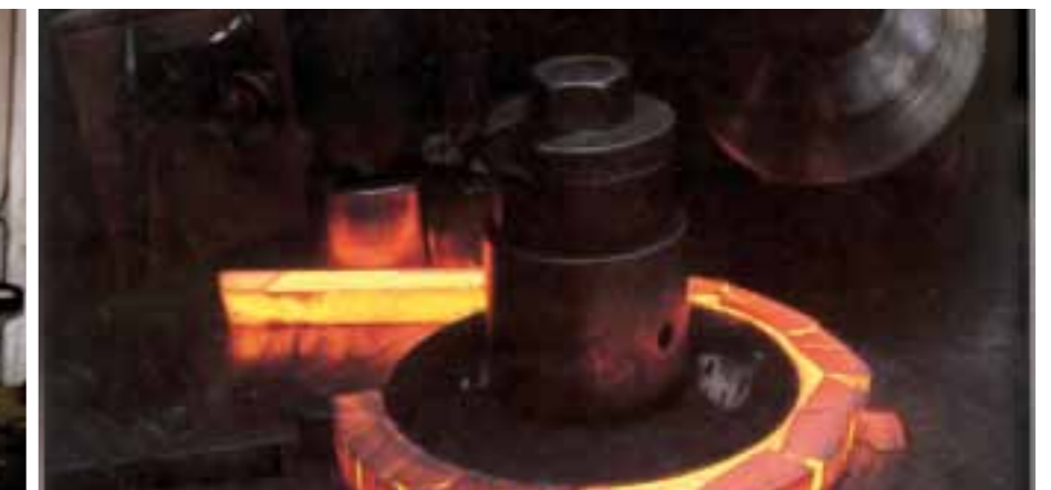
Curvadoras de anillos con mesa rotatorio ideal para barras y angulos utilizados para la fabricación de arandelas y sedes de cojinetes. Capacidad hasta 70.000 mm 2 de sección.
