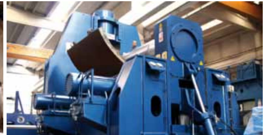
La capacidad de curvatura más grande (3500x280 mm en frío) se ha obtenido en el 2009 con el modelo HAV 15/S.
