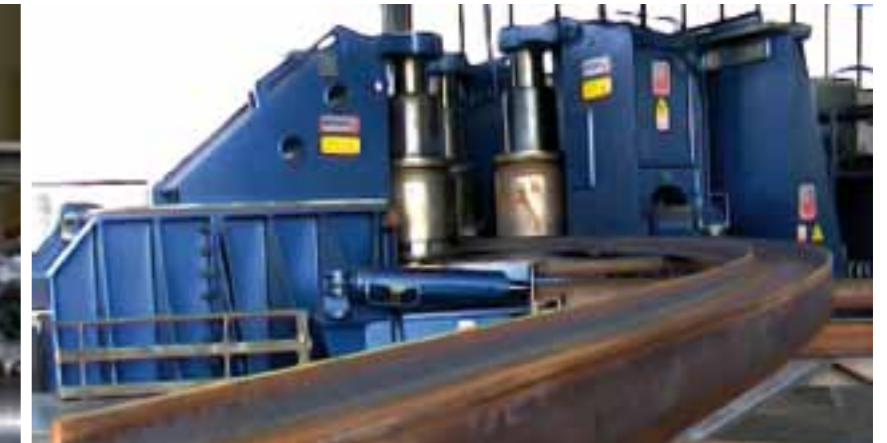
Curvadoras con geometría variable para perfiles estructurales de 300 hasta 17.000 cm 3 de módulo de resistencia.
