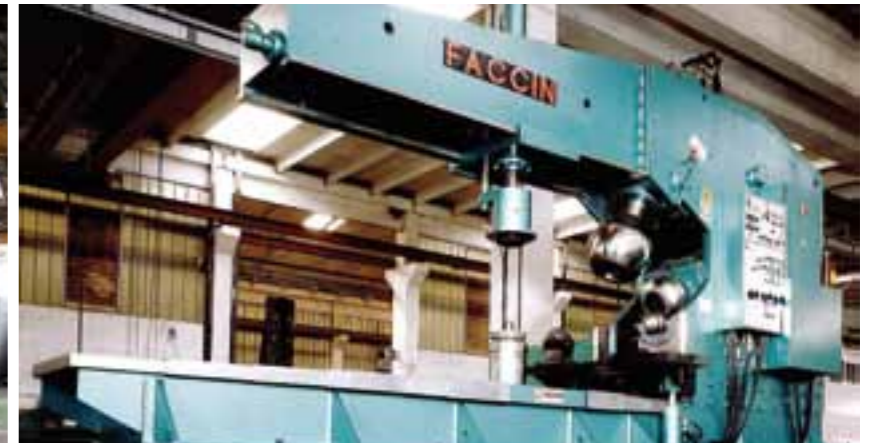
Bordonadoras automáticas están disponibles con diferentes diseños para fondos con y sin agujero central. Controles CNC están disponibles.
