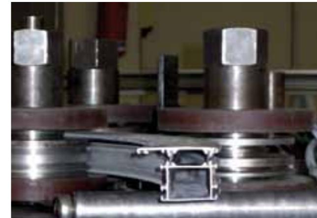
Versiones y utillajes especiales para la curvatura de formas complejas y extrusionado de aluminio.
