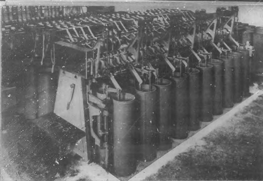
Juego de manuales estiradores y repasadores de fibra de yute o kenaf.
