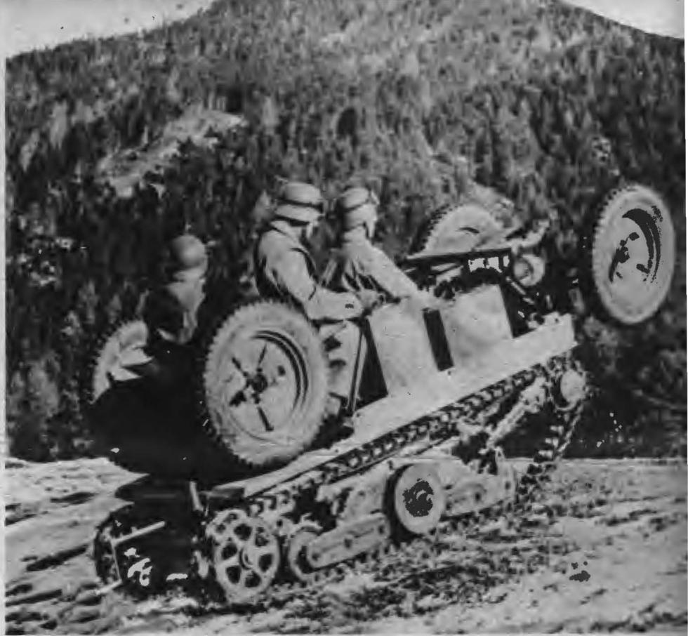
Un tanque ligero de montaña. Estas tanquetas poseen ruedas neumáticas y tracción tipo oruga.
