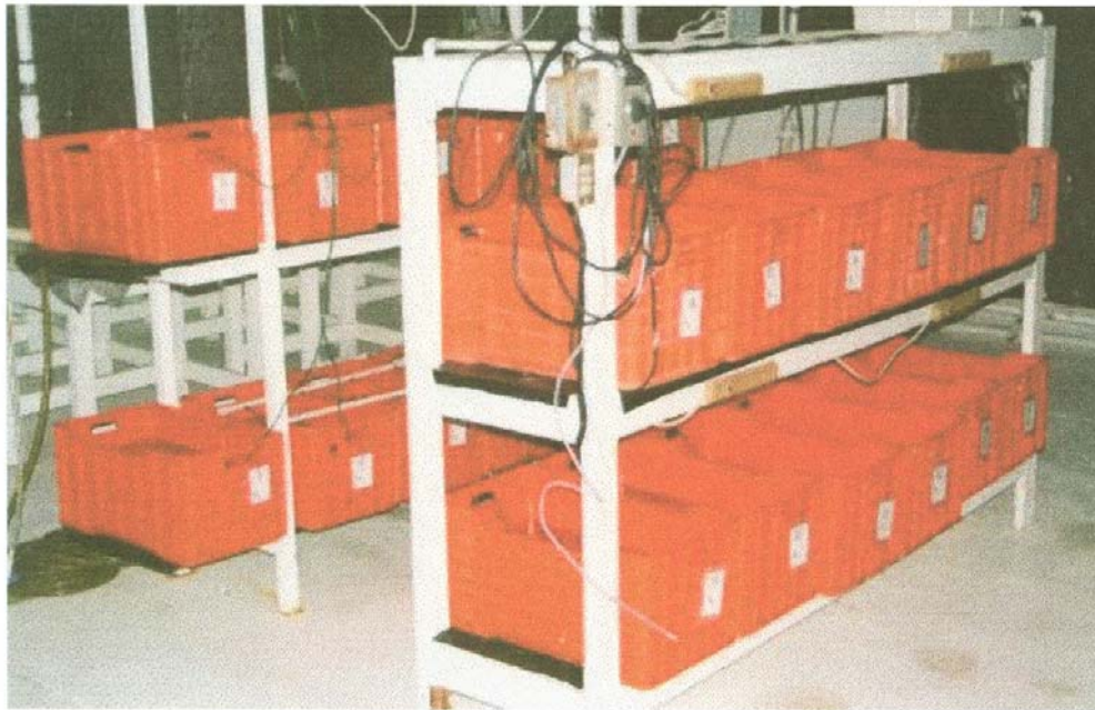
FIGURA 3. Sistema de cultivo en condiciones de laboratorio utilizado para la evaluación de dietas con langostilla para Litopenaeus stylirostris y L. vannamei .
