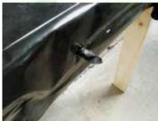
**Figura 7.7** Sistema de drenaje con una manguera.
