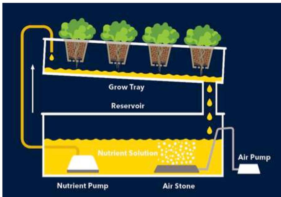
**Figura 7.10** Sistema hidropónico con recirculación de sustancia nutritiva.
