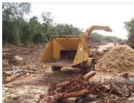
Figura 19. Imágenes de la trituración de material vegetal producto del desmote.
