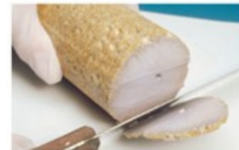
▲ Taglio di sodio metallico Il sodio, un metallo reattivo, è coperto da uno strato di ossido che lo protegge.
