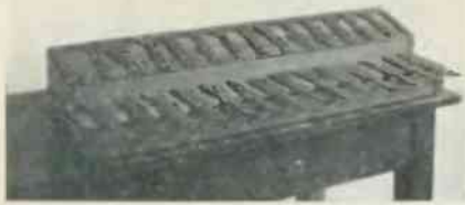
5. Aparat, służący do badania zdolności odróżniania kształtów i form. Z dolnego szeregu należy brać różne wykroje blaszane i wstawiać je do górnego szeregu łam, gdzie one dadzą się włożyć, i to w jak najkrótszym czasie.
