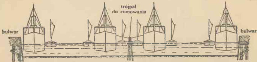
Przekrój basenu portowego.
