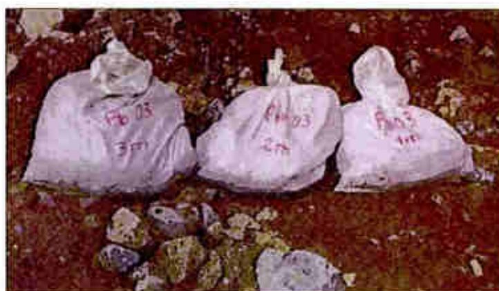
FOTOGRAFÍA 3-5. Muestras Identificadas por Pozo y Profundidad (relacionadas con el horizonte de capa).
