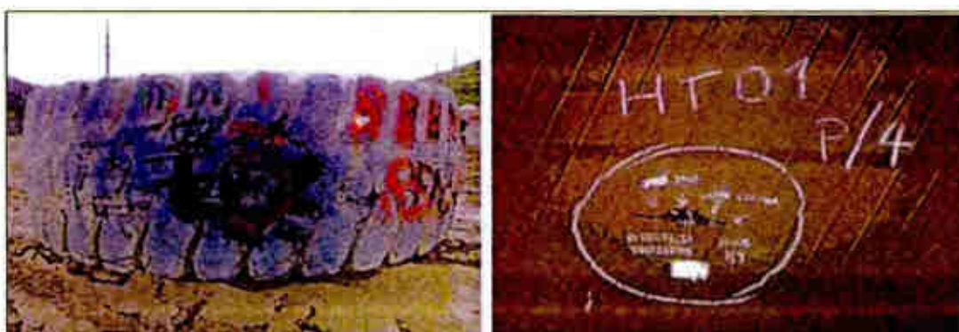
FOTOGRAFÍA 4-2. Corte Pasante en Banda de Rodamiento.
