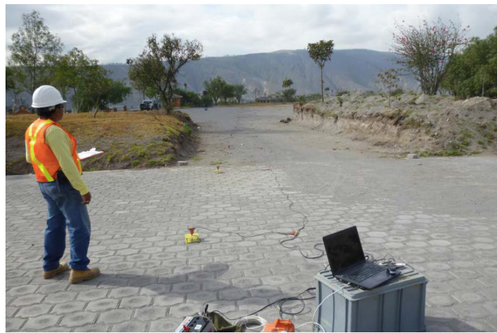
Figura 12. Arreglo sísmico típico para adquisición de ondas superficiales
