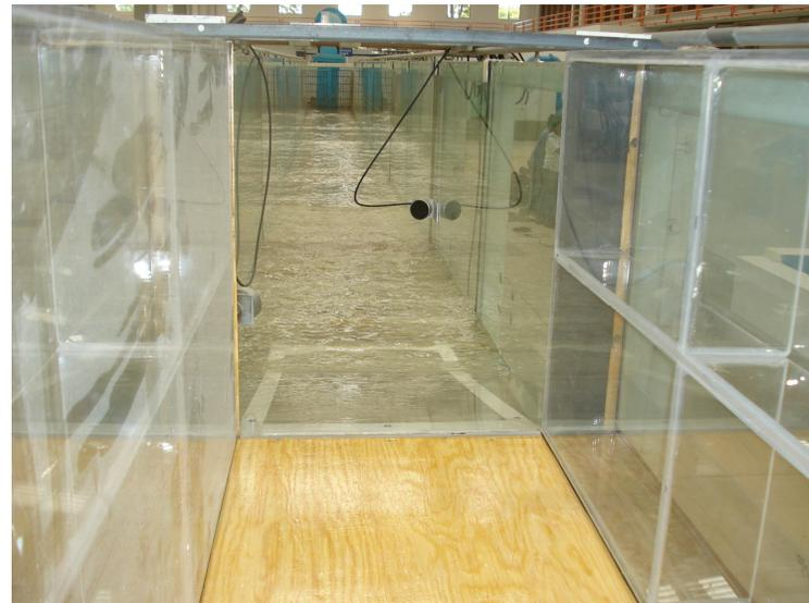
Instalación en el canal de pendiente variable.
