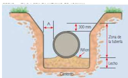
Figura 69. Zanja tipo (Flowite)
