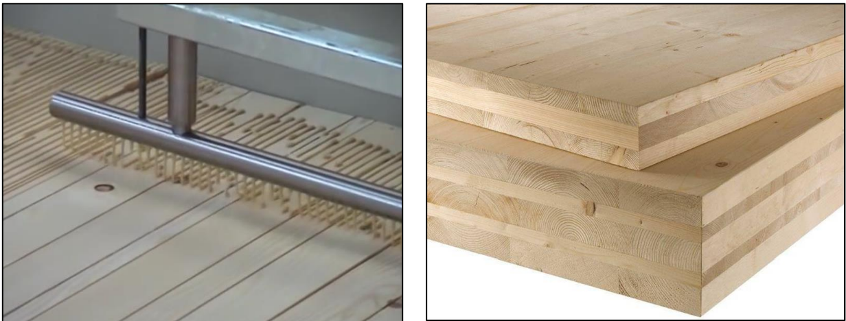
Figura 2.2 (a) Proceso de encolado de una capa del panel CLT. (b) Panel CLT terminado.
