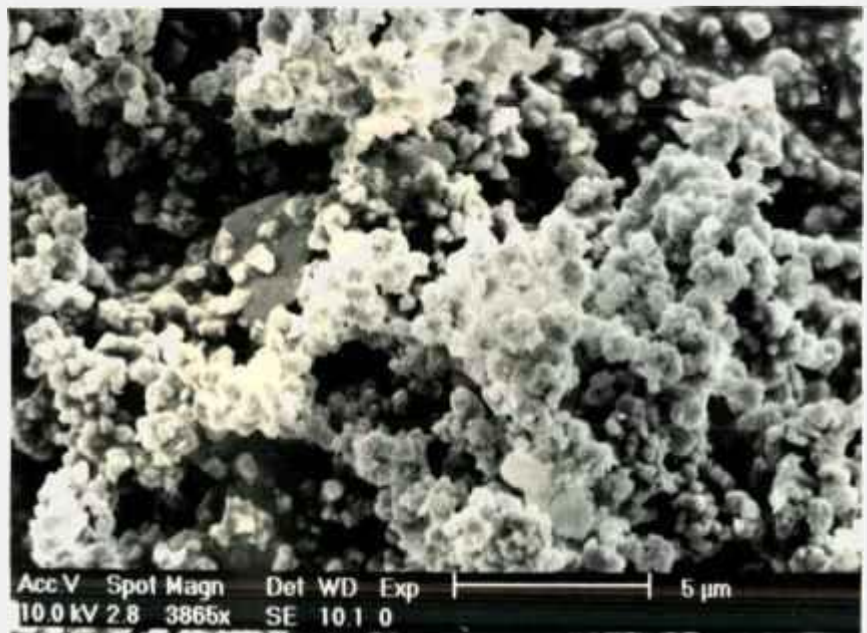
FIGURA 3.2: Micrografia Eletrônica de Varredura da Zircônia-Magnésia tipo MSZ-8.
