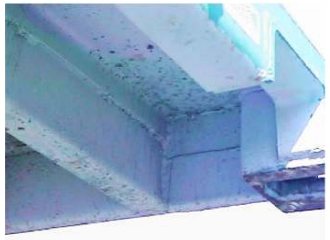
**Estructura externa inferior del contenedor.** Esta inspección debe ser realizada en la recepción del contenedor y/o en la entrega lleno al naviero en el sitio indicado para su transporte marítimo.
