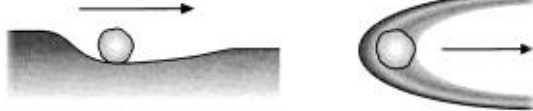
Marcas de Herradura (Obstacle scour)
