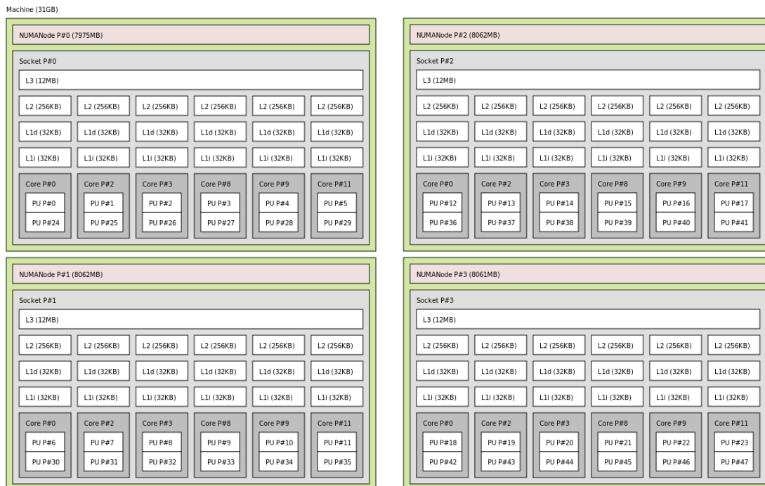
Figura 2.1: Estructura de un sistema multicore con arquitectura NUMA.
