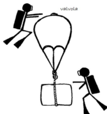
Fig. 63: Esquema de una operación de levantamiento de un hallazgo con el globo
