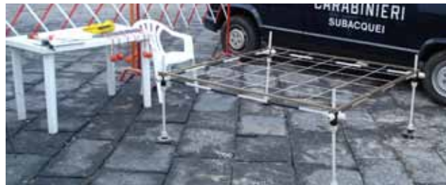
Fig. 52: Cuadrado y subdivisión interna con hilos metálicos. Ejercitaciones de ensamblaje
