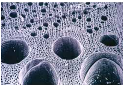
Fig. 36: Estructura celular de una latifolia
