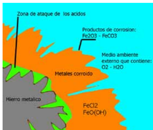
Fig. 32: Esquema de alteración del hierro en ambiente aéreo
