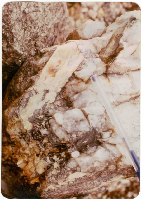
05-09/GP/EK-495.- Cristal subidiomorfo de espodumena en pegmatita de litio -- ( FP_{Li} ). Tonalidad verde del cristal de bid a a contenido en cromo (paso a hidde n ita = variedad verde de espodumena).
