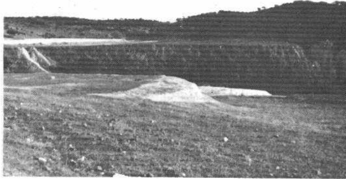
Foto 15.— Serie de balsas y escombreras en las minas de calcopirita de Cerro Muriano (Córdoba). En el centro escombrera de escorias, obsérvese las balsas una en primer plano, y otra situada encima de la escombrera.
