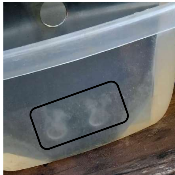
Figura 2: Placa de acero inoxidable recibiendo energía y realizando la electrólisis.
