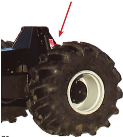
Cilindros hidráulicos de doble efecto para oscilación de eje trasero
