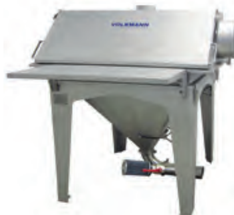
Estación de alimentación del producto con extensión del volumen de llenado y boquilla de bolsa vacía lateral.
