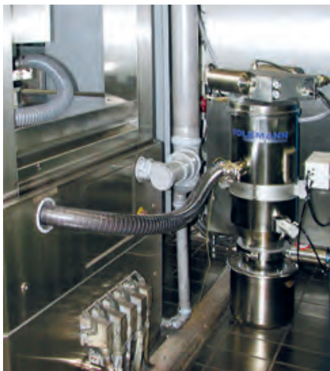
El polvo que se genera dentro de la prensa de comprimidos durante el proceso de prensado se aparta por medio de aspiradoras industriales.
