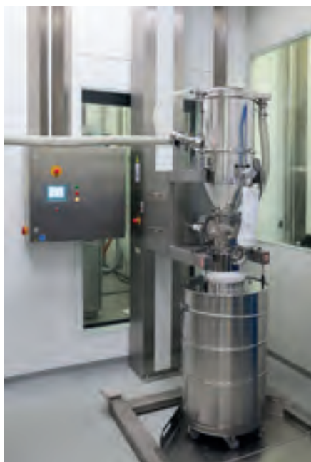
Dosificación de los materiales activos con la ayuda de un PPC 350 VS y una Rotatoria de dosificación.
