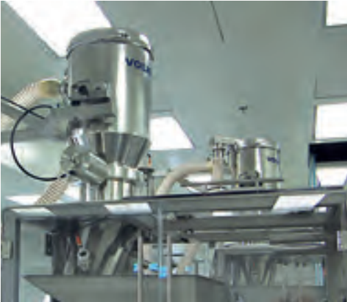
Alimentación de una máquina de envasado de comprimidos.
