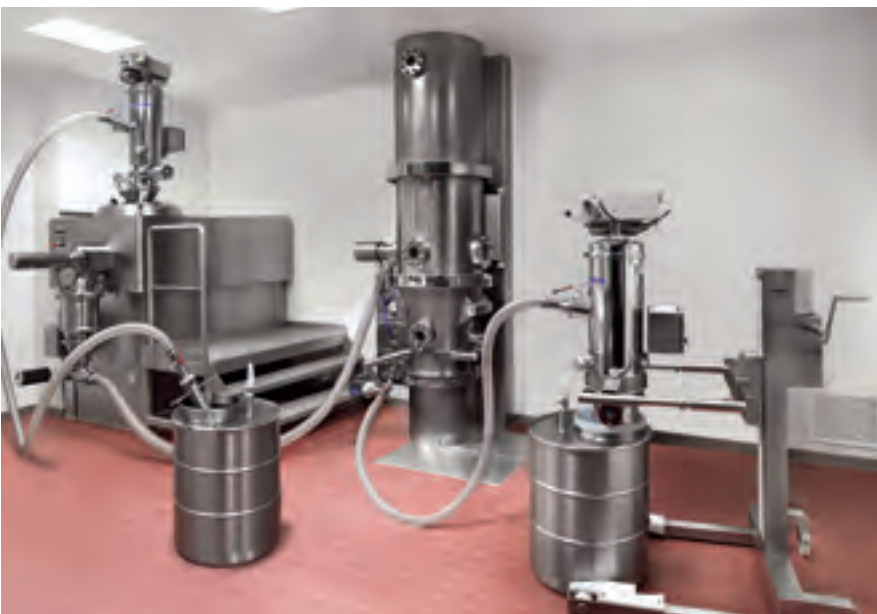
Vaciado del tanque y alimentación del mezclador; vaciado de un secador de lecho fluido y llenado del tanque.
