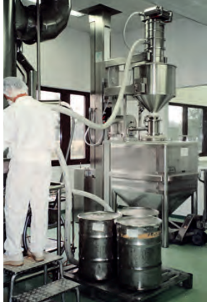
Vaciado de un secador con tubo de aspiración manual.
