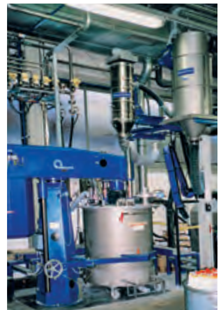
Transportador por vacío para el transporte de pigmentos para la fabricación de lacs.
