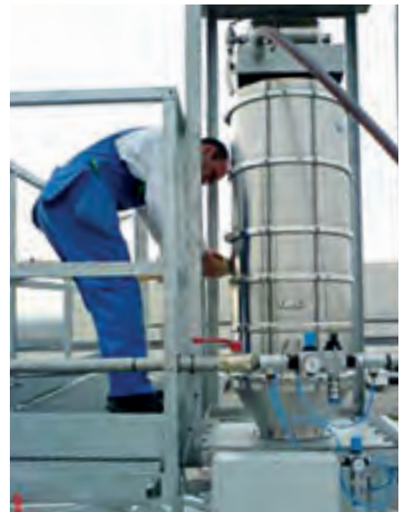
Transportadores por vacío en la instalación al aire libre para la alimentación de silos
