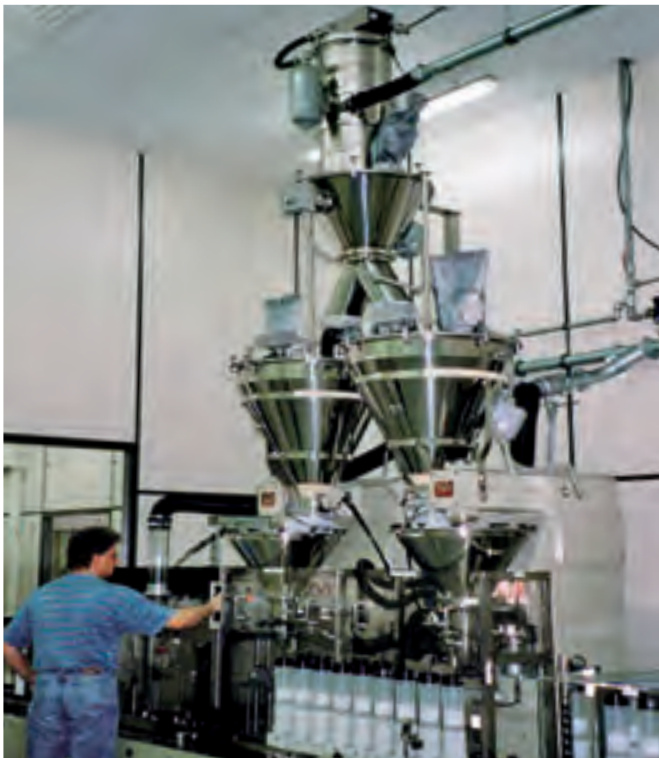
Alimentación de una planta de rellenado de tóner.
