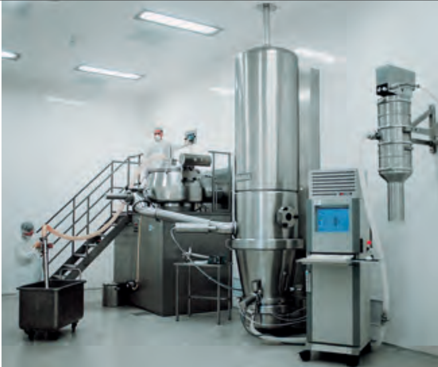
Transportadores por vacío para el vaciado automático de secadores de lecho fluido. Descarga del producto a través de un tubo de inmersión en IBC.
