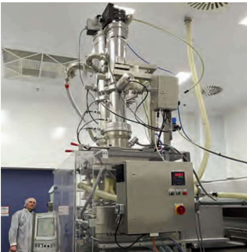
Alimentación de dos polvos distintos (ingredientes farmacéuticos activos (API)) en una máquina multipista.
