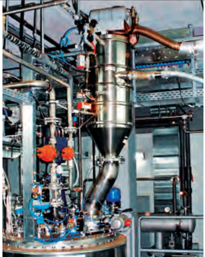
Transportadores por vacío con función de bloqueo para el transporte de pigmentos en una atmósfera de disolventes.
