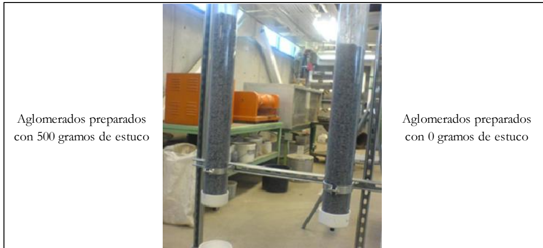
Figura 2. 23 Columnas cargadas con los aglomerados (Kodali, 2010)
