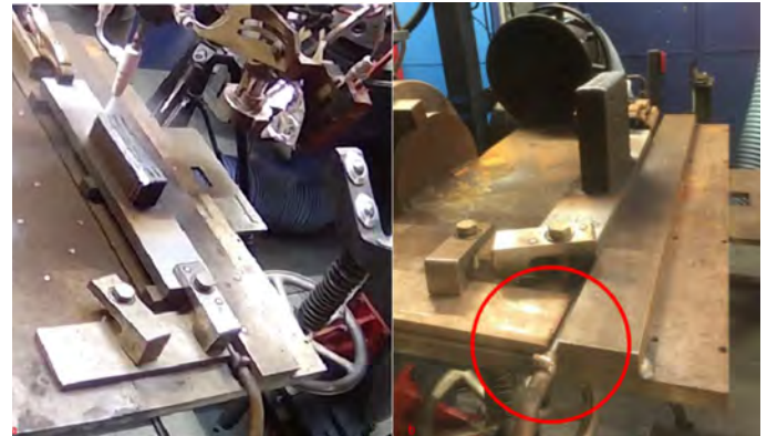
Figura 12. Sistema de refrigeración adicional bajo el sustrato. Pieza en proceso (a), y acabada (b).
