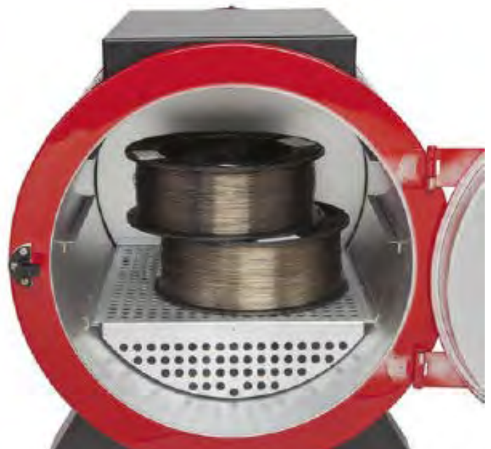
Figura 3. Horno para almacenamiento y reacondicionado de consumibles. Cortesía de LINCOLN ELECTRIC.
