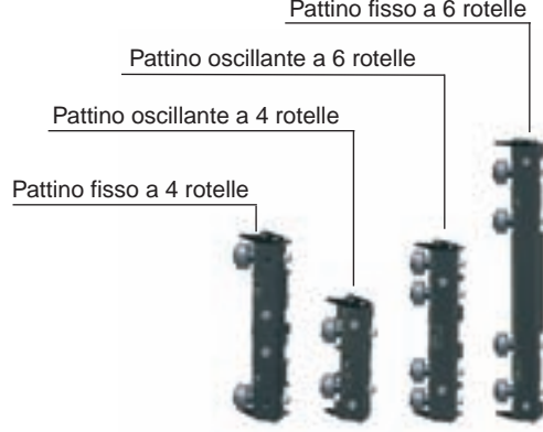
Pattini con rotelle Ø52 e Ø62 (guida a V 55x25)
