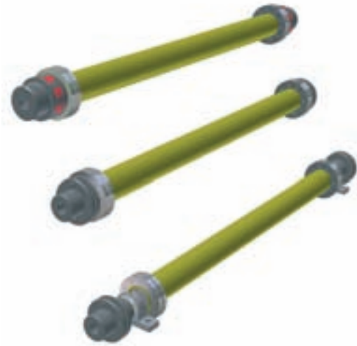
Tipo 1 - Collegamento con giunti elastici, normalmente adatto a basse velocità con interasse e lunghezza fino a 2 m.
