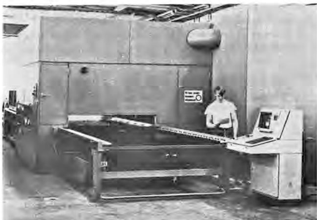
La nueva línea HTF tiene unidades de control tanto en el lado de entrada como en el de salida. La persona que controla la salida puede vigilar el proceso de enfriado y corregir inmediatamente cualquier perturbación.
