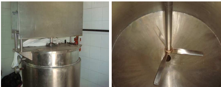
Figura 4. Aspas de equipo de lixiviación dinámica (derecha).
