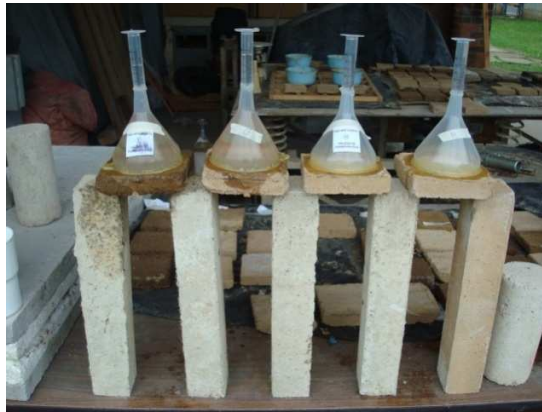
Figura 49. Ensayo de permeabilidad al agua. Centro de Investigaciones de Ingeniería.
