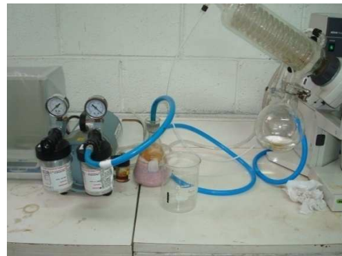
Figura 18. Bomba que produce el vacío del proceso de roto-evaporación (derecha).
