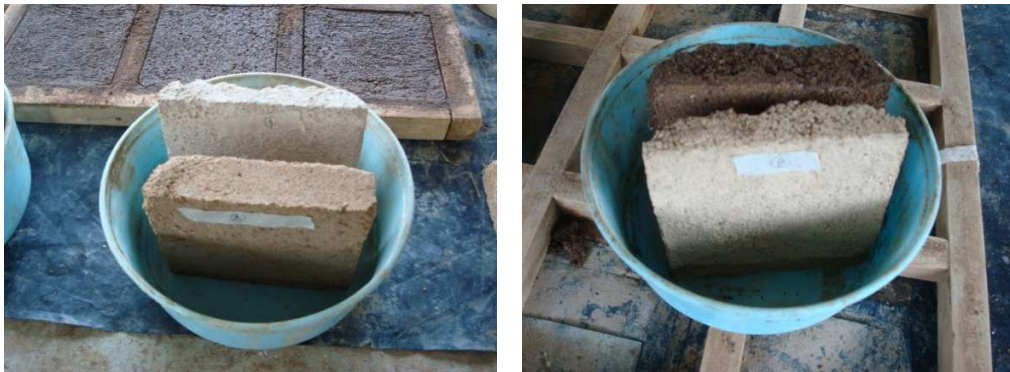
Figura 47. Ensayo de absorción por capilaridad. Centro de investigaciones de Ingeniería. Figura 48. Ensayo de absorción por capilaridad. Centro de investigaciones de Ingeniería.
