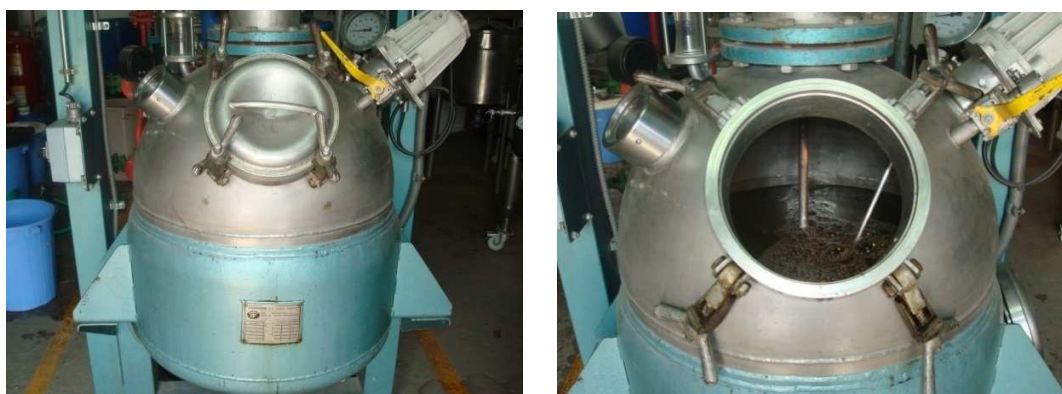
Figura 9. Marmita con enchaquetado para el proceso de concentración (izquierda). Figura 10. Final de proceso de concentración (derecha).
