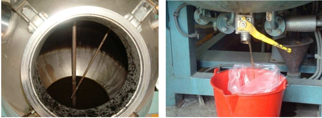
Figura 12. Descarga de la solución de concentración (derecha).
