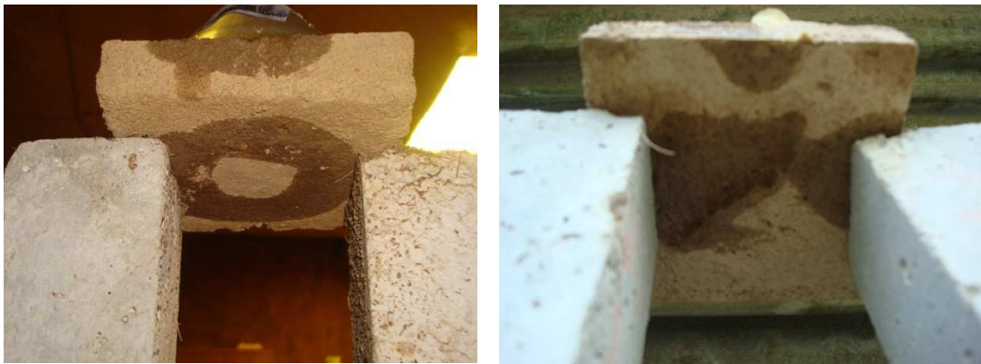
Figura 50. Aparición de humedad en el ensayo de permeabilidad al agua. Figura 51. Aparición de humedad en el ensayo de permeabilidad al agua.
