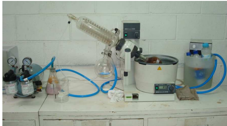
Figura 16. Proceso de roto-evaporación.
