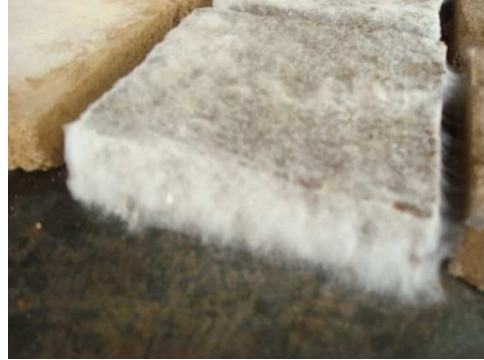
Figura 54. Eflorescencias al secado, Nuançages y manchas.
