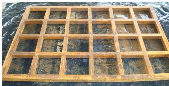
Figura 39. Molde de madera utilizado para la fabricación de mezclas.
