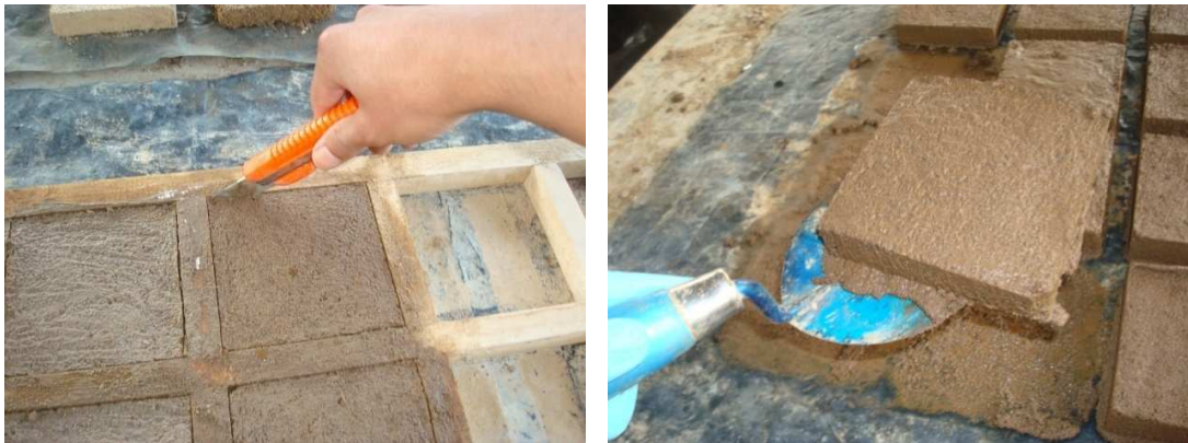
Figura 44. Extracción de las mezclas del molde. Centro de Investigaciones de Ingeniería. Figura 45. Extracción de las mezclas del molde. Centro de Investigaciones de Ingeniería.
