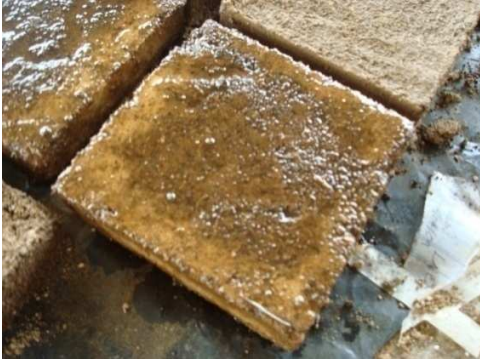
Figura 54. Eflorescencias al secado, Nuançages y manchas.
