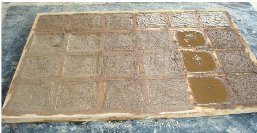
Figura 43. Molde completo con ocho diferentes mezcla. Centro de Investigaciones de Ingeniería.
