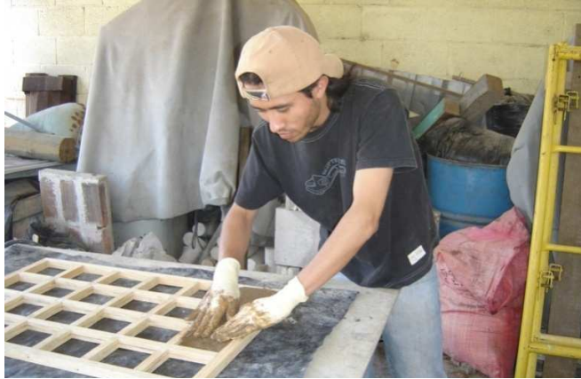
Figura 42. Colocación de la mezcla dentro del molde. Centro de Investigaciones de Ingeniería.
