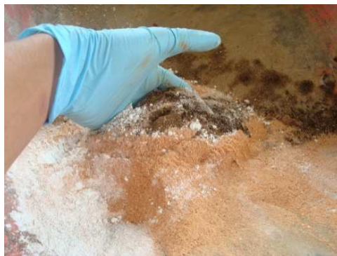
Figura 32. Aplicación de sustancias al mortero fresco.
