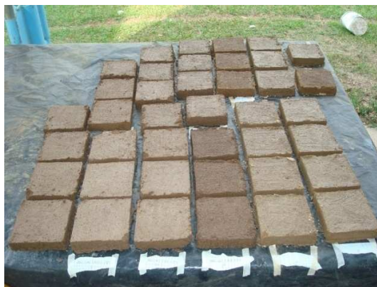
Figura 46. Muestras debidamente identificadas listas para secar durante 28 días.
