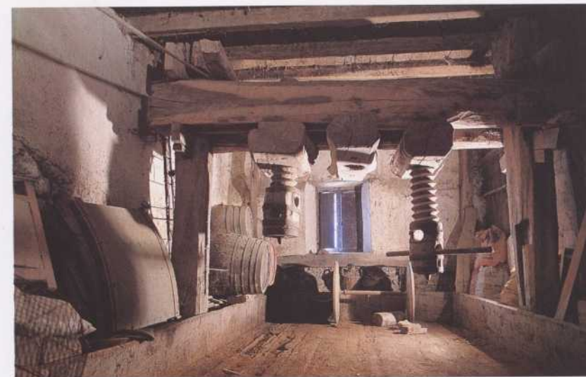
96. Azkunabieta baserriko (Urniet) hiru ardatzeko dolarea. XVII. mendearen bukaeran, zukua lauskitzeko sagar ore zuzenean zanpatzen zuten hiru torloju bertikalez zuzkituriko dolareak hedatu ziren Gipuzkoa eta Nafarroan.
