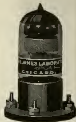
AN R. F. TRANSFORMER
