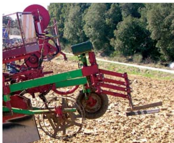
8-9. In funzione del tipo di terreno le macchine per l'impianto possono essere dotate di varie tipologie di rulli costipatori e dischi rinalzatori
