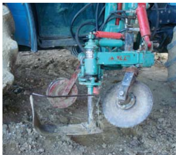
10. Lametta scalzante ventrale dotata di disco anteriore e ruota di appoggio
