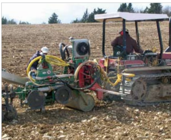
6. Impianto meccanizzato a radice corta (in buca) con irrigazione contemporanea alla messa a dimora
