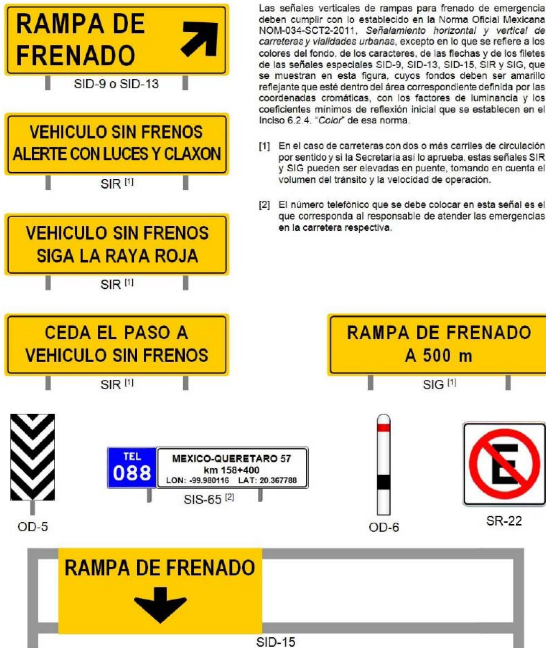
Figura 8.- Señales verticales de rampas para frenado de emergencia
